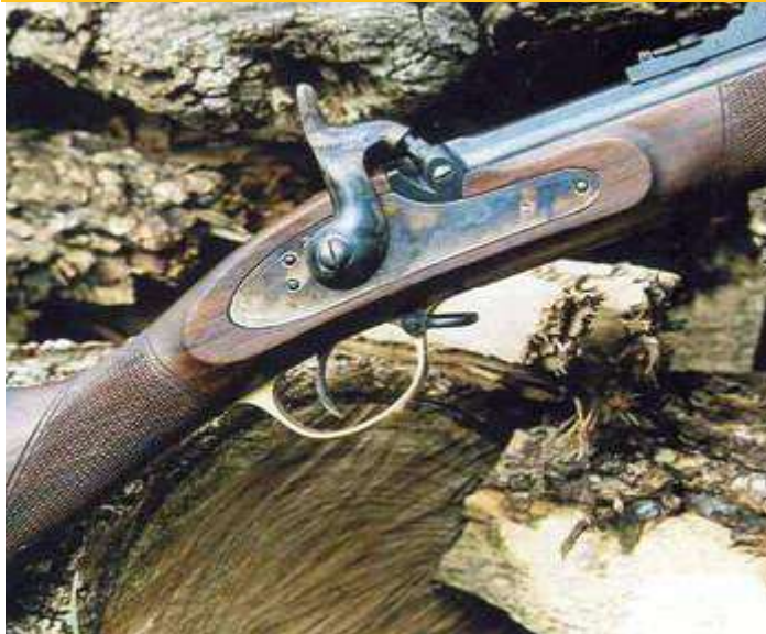
Meccanismo a percussione con cane abbattuto sul luminello
